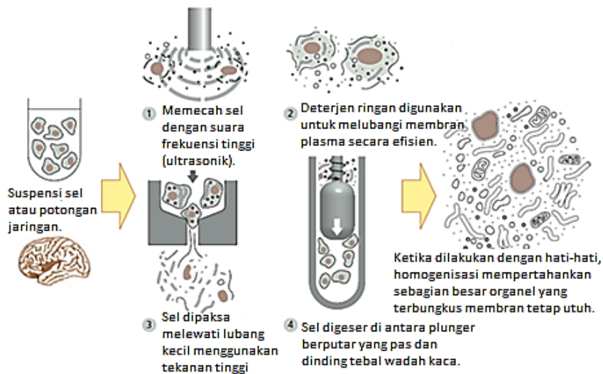
Gambar 13.5. Berbagai Metode yang Digunakan dalam Pelisisan Sel: 1) Sonikasi, 2) Lisis Sel Berbasis Larutan, 3) Metode French Press, 4) Metode Potter-Elvehjem Homogenizer
