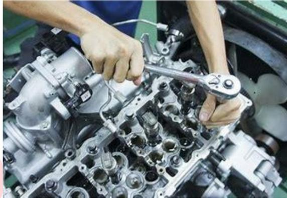
**Gambar 3.17. Pemeliharaan Mesin**
