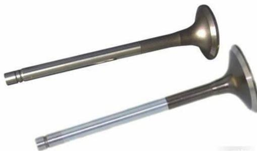
**Gambar 1.5. Katup intake dan exhaust**
