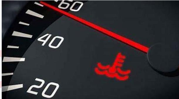
Gambar 2.3. Indikator Suhu Mesin
