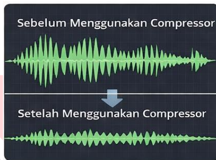
Gambar 40. Perbandingan Gelombang Audio Sebelum Dan Sesudah Menggunakan Compressor
