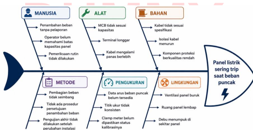
Gambar 13. Contoh Diagram Sebab Akibat untuk Kasus Panel Listrik Sering Trip
